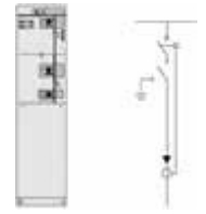
V – Vakum Kesicili ünite -toprak bıçağı ile beraber 200A / 630A nominal akım, 21kA 3(s) kısa devre dayanım
